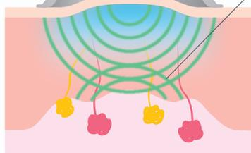
皮下組織が真皮と異なる伝導性・誘電率を持つため、マイクロ波は皮下組織で反射します。
